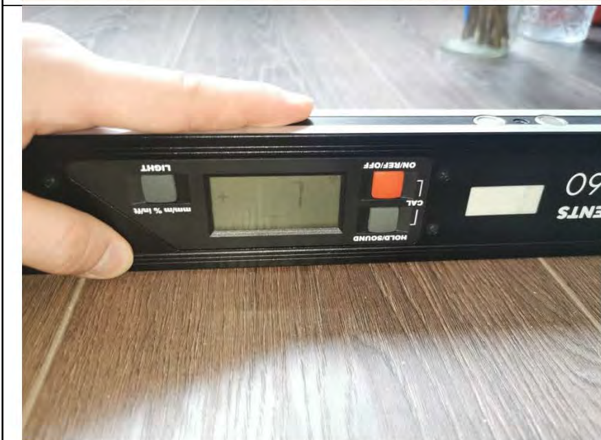
Фото №27. Измерение уровня пола в спальне.
