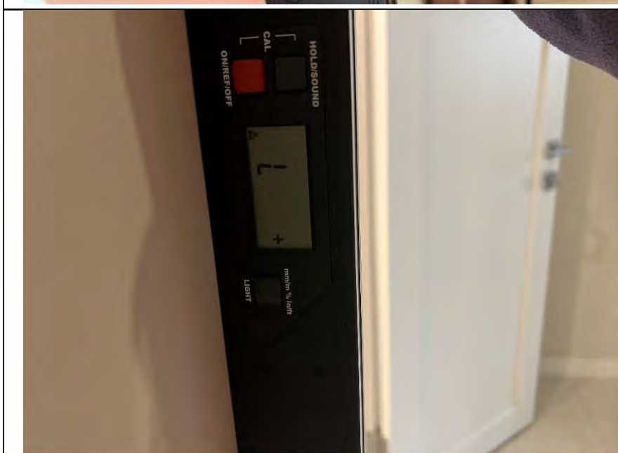
Фото №18. Измерение уровня стен в прихожей.
