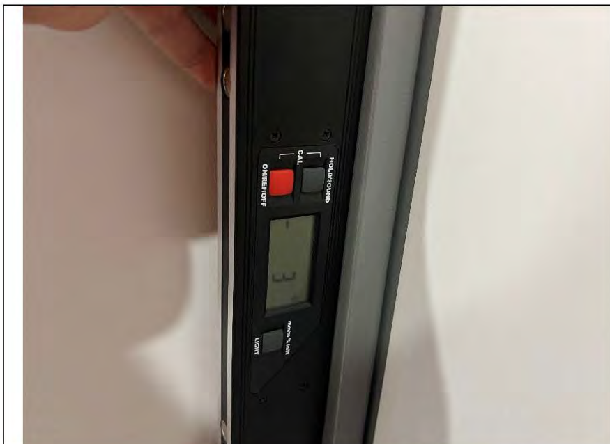
Фото №82. Отклонение коробки входного дверного блока по уровню вертикальности составляет 3 мм.
