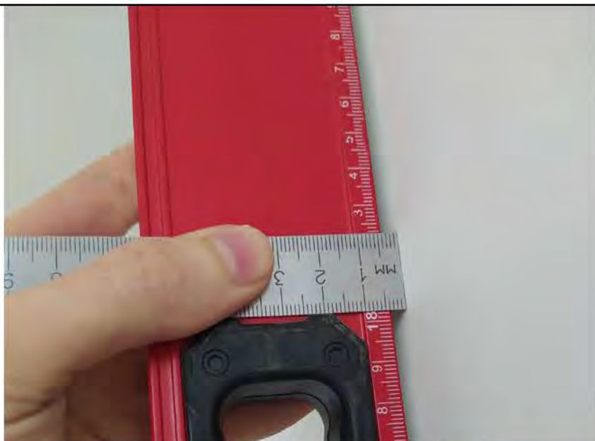
Фото №10. Измерение уровня стен в спальне.
