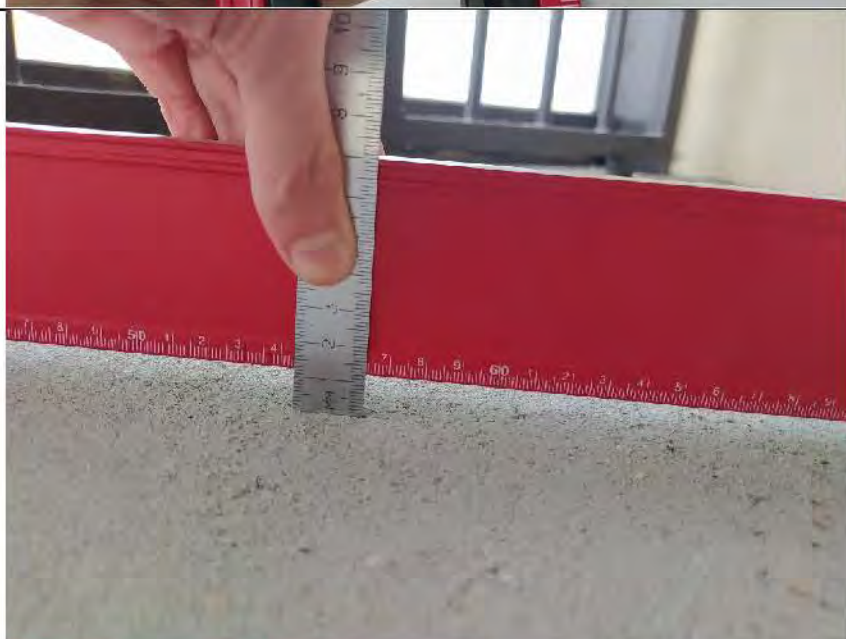
Фото №11. Измерение уровня стяжки пола на лоджии.
