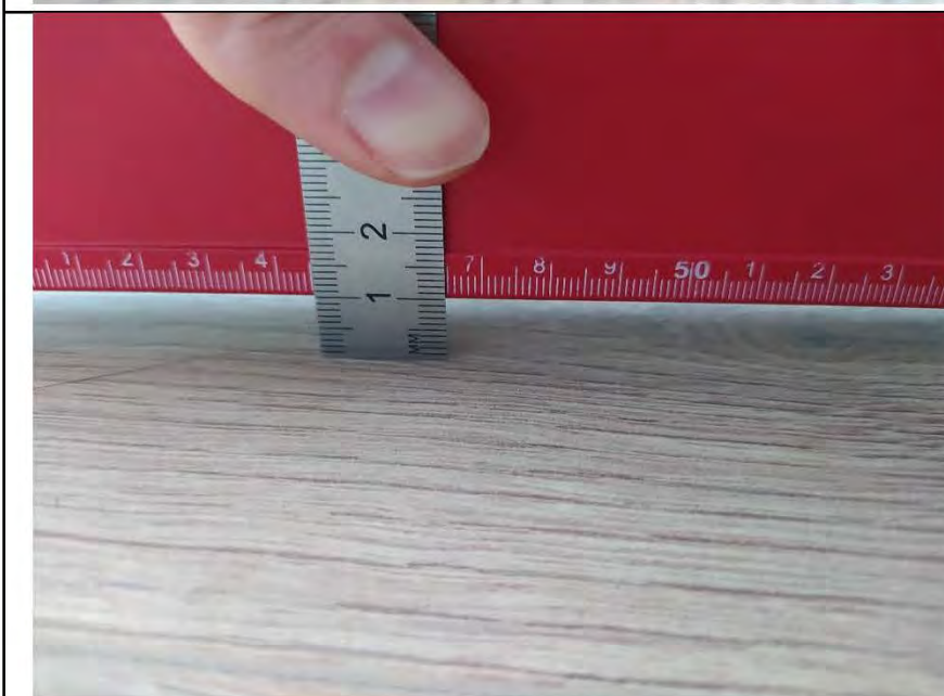
Фото №17. Измерения уровня напольного покрытия в кабинете.
