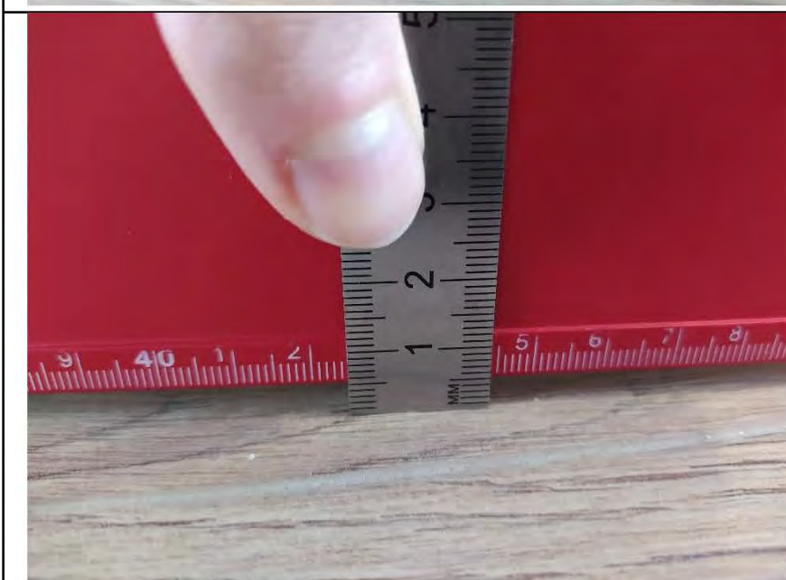
Фото №18. Измерения уровня напольного покрытия в прихожей (ламинат).
