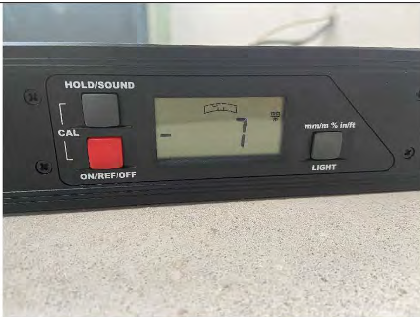
Фото №73. Отклонения поверхности напольного покрытия от плоскости в квартире.
