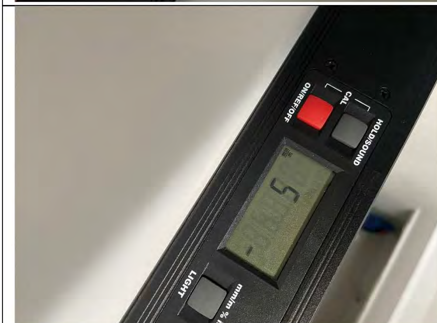
Фото №68. Измерение стен по уровню вертикальности в квартире.
