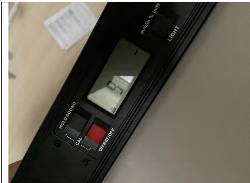
Фото №67. Измерение стен по уровню вертикальности в квартире.
