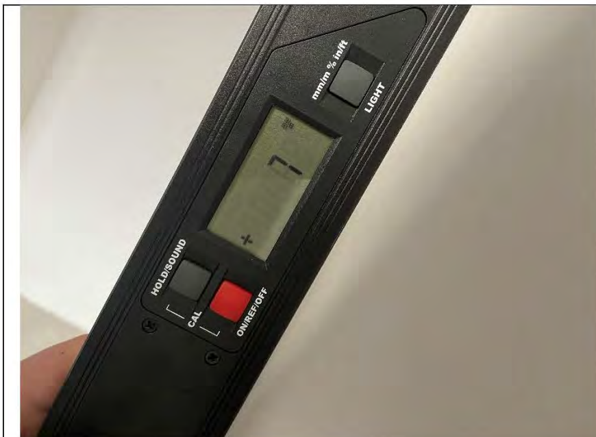
Фото №70. Измерение стен по уровню вертикальности в квартире.
