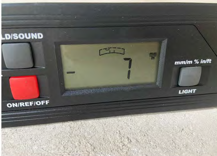
Фото №77. Отклонения поверхности напольного покрытия от плоскости в квартире.
