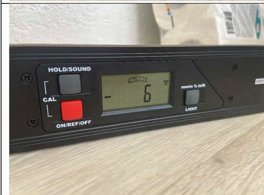
Фото №14. Отклонение напольного покрытия из ламината в кухне.
