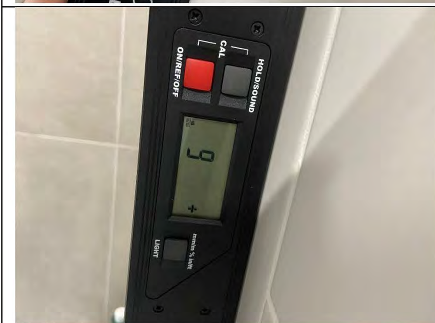
Фото №9. Измерение уровня стен в ванной комнате.
