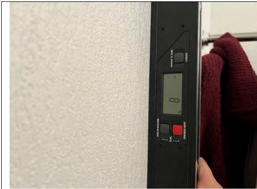
Фото №7. Измерение уровня стен в гардеробной.
