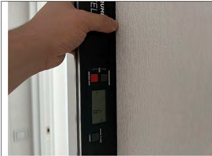
Фото №10. Измерение уровня стен в прихожей.
