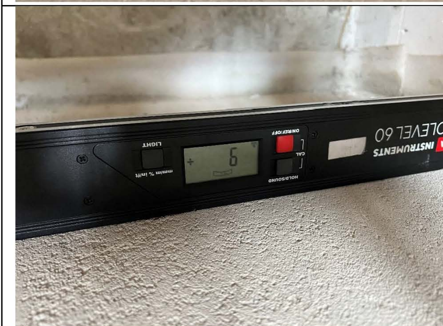
Фото №11. Измерение уровня стяжки в ванной комнате.
