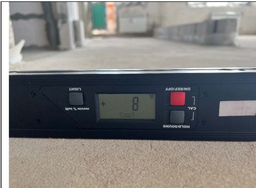
Фото №10. Измерение уровня стяжки в коридоре.
